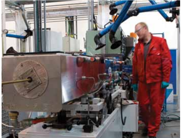
必要な結晶化度を得るために加工設備を適切に調整
