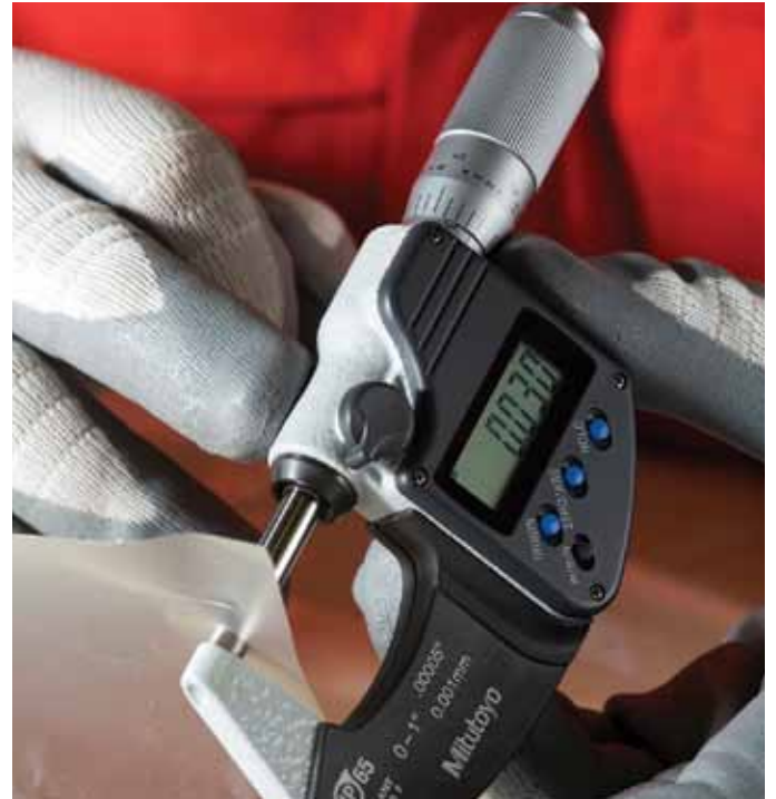
押出成形された APTIV PEEK フィルムの厚み計測
