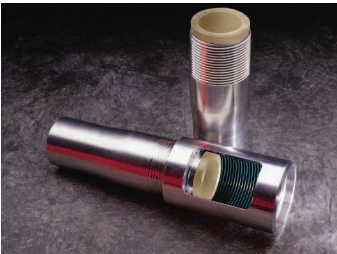
VICTREX™ PEEK 폴리머는 유전산업에서 사용하는 내마모성 배관을 위한 고기능 라이너에 사용되며 PEEK는 화학물질과 가스 투과를 막아줍니다.
