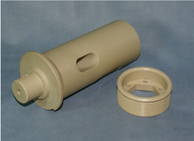
고온의 살균공정을 견디고 내마모성을 갖춘 VICTREX™ PEEK 폴리머는 음료용 병입 설비의 스테인리스 강 밸브와 하우징을 대체할 수 있습니다.
