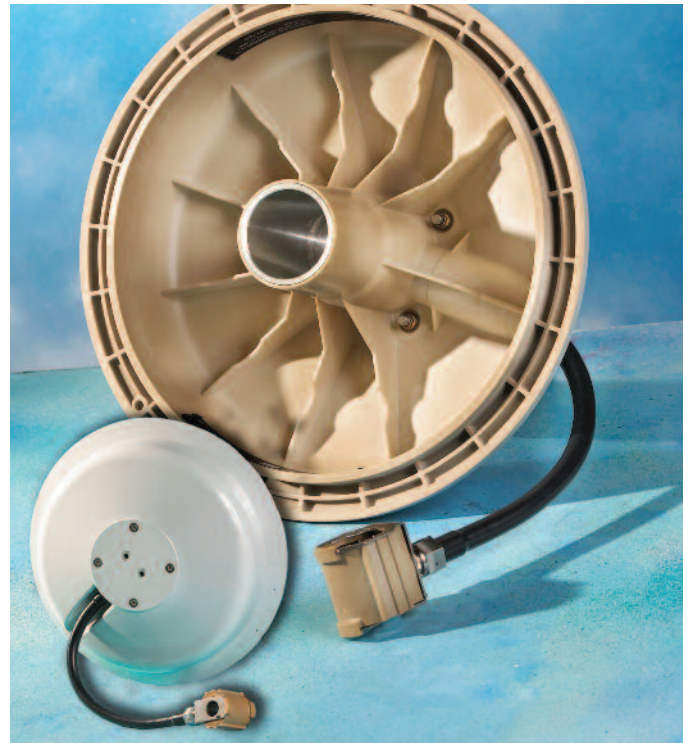
비행기 착륙기어 허브 캡에 적용되는 VICTREX™ PEEK 폴리머는 공중파편의 충격을 견딜 수 있으며 약조건에서도 우수한 내환경성을 보입니다.
